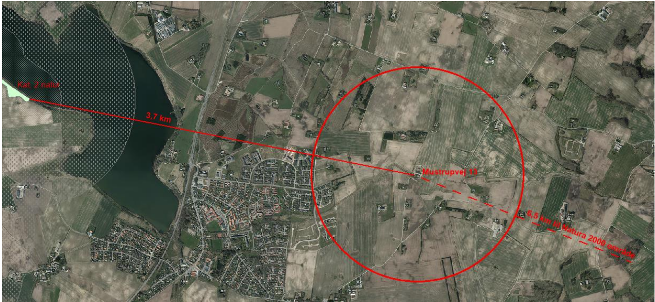
Figur 1: Anlægget ligger med 6,5 km til kategori 1 natur og 3,7 km til kat. 2 ammoniakfølsom natur, jf. § 7, stk. 1, nr. 2 i husdyrbrugloven. Omkring anlægget er der med en cirkel angivet en afstand på cirka 1 km. Denne er vist mere detaljeret på figur 2.
